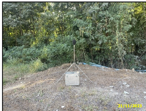
ภาพที่ 3.13 การตรวจวัดระดับเสียงบริเวณโรงแต่งแร่ของโครงการ
